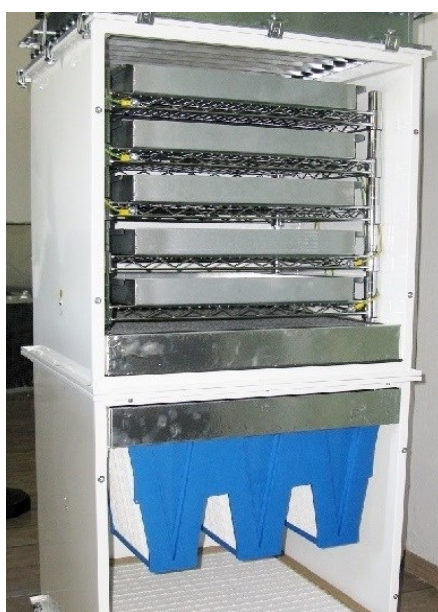
Contenitore di scarica del filtro mediante vapore saturo di IPA (camera aperta).
